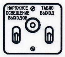
Табло включения освещения выходов. Рис. 3.
