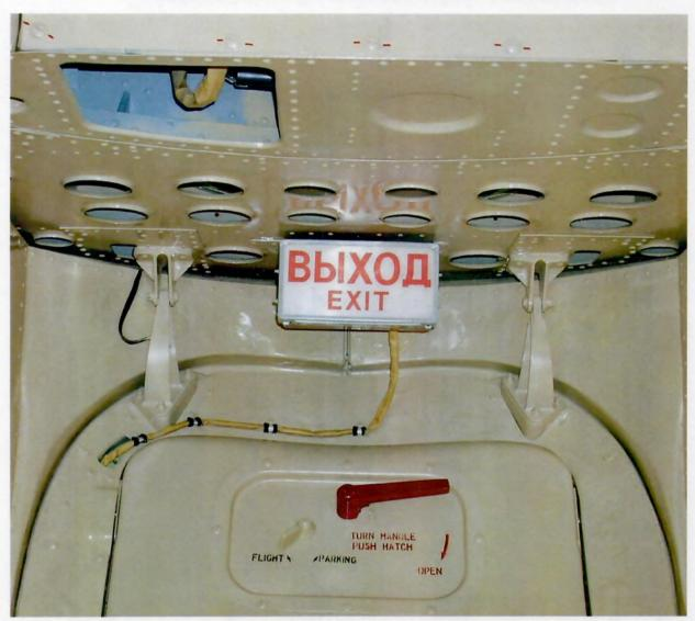
Установка указателя светового СУ-2 у грузовых створок. Рис. 1.
