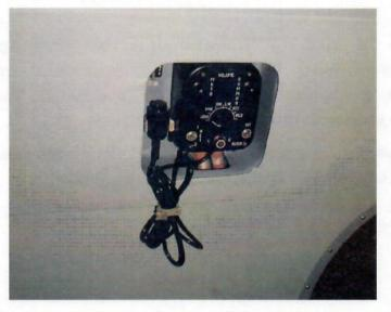
Размещение дополнительного абонентского аппарата на левом борту в грузовой кабине. Рис. 1.
