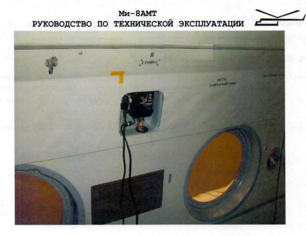
Размещение дополнительной переговорной точки на правом борту в грузовой кабине.
