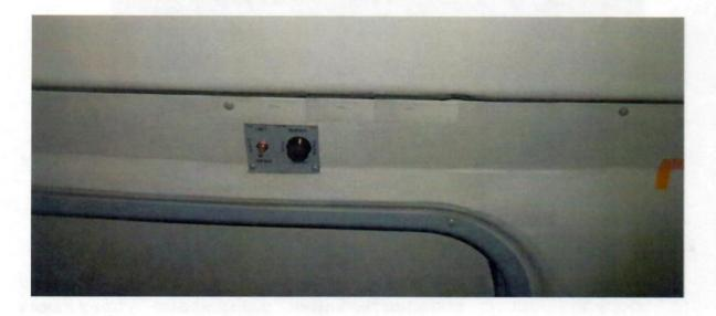
Размещение дополнительного пульта управления третьей фарой на правом борту в грузовой кабине. Рис. 1.
